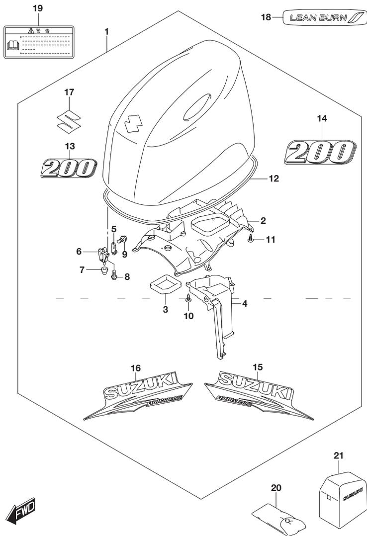
FIG.420B (1-F-14) エンジン カバー (FOR Y5S)(DF200AT)
