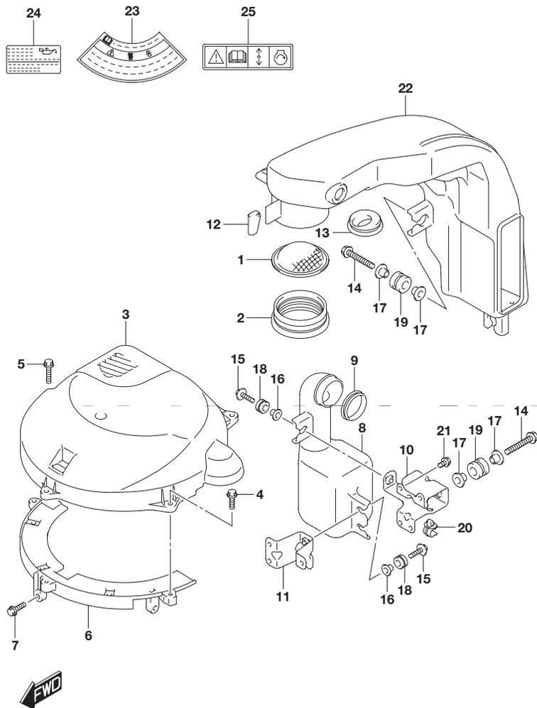
FIG.135A (1-B-14) サイレンサ/リングギアカバー
