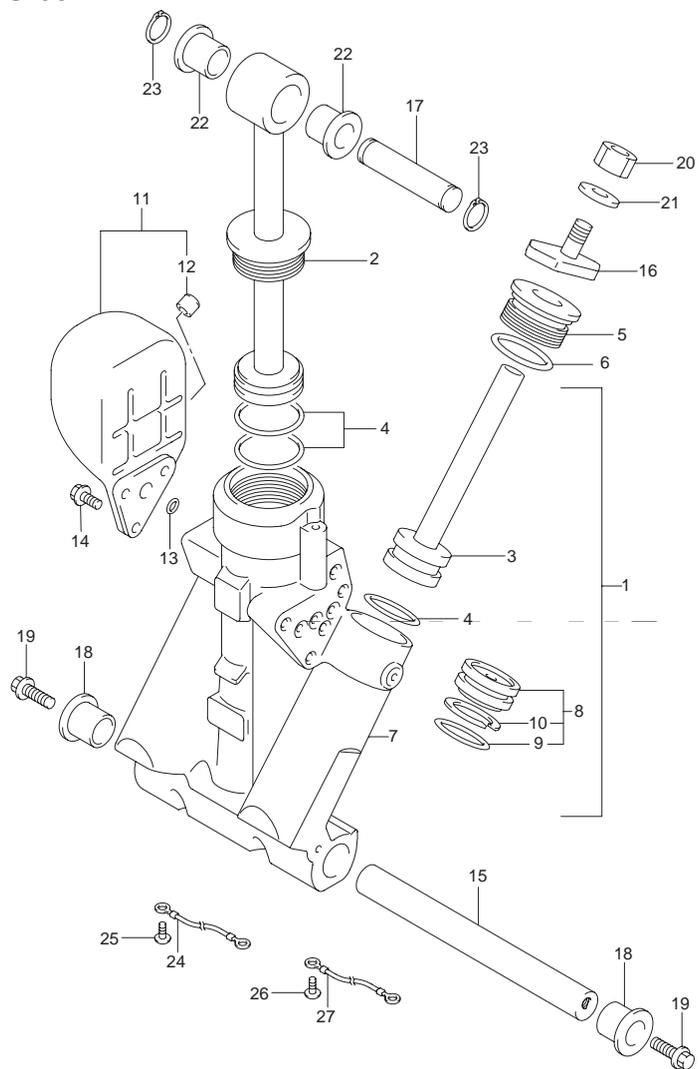
**FIG.60 (1-H-13) トリム シリンダ トランサム(L)(DF200T)**
