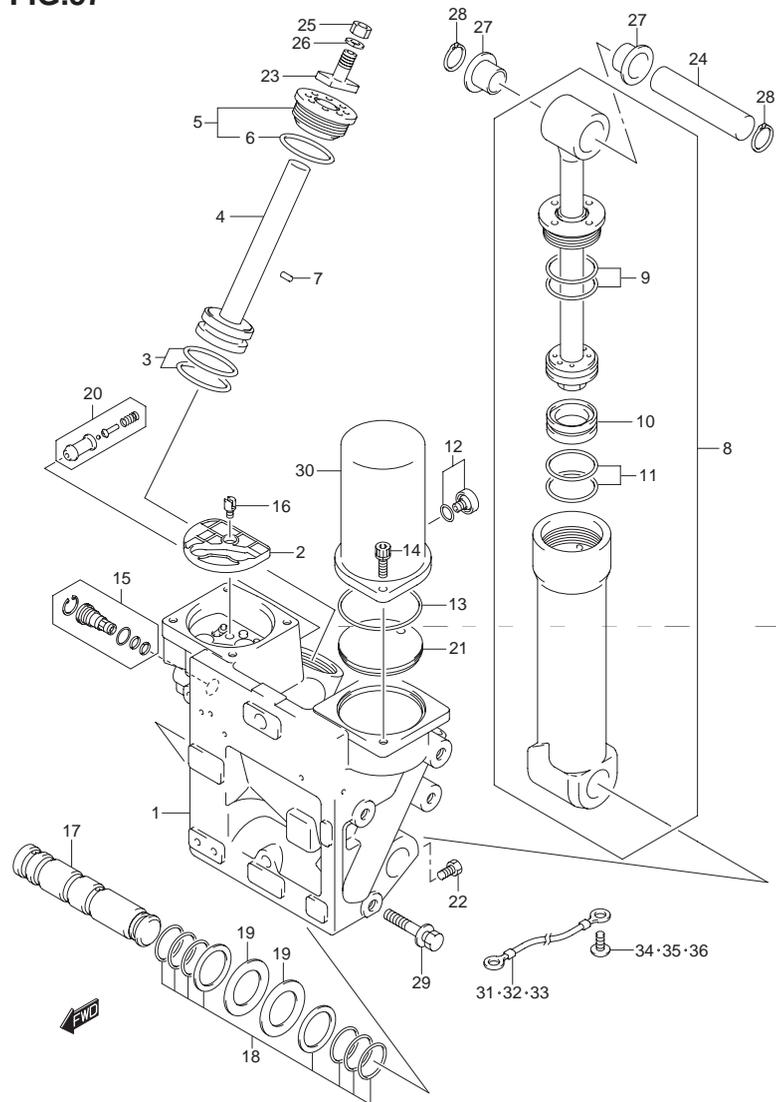
FIG.57 (1-H-6) トリム シリンダ トランサム(X)(DF200T)
