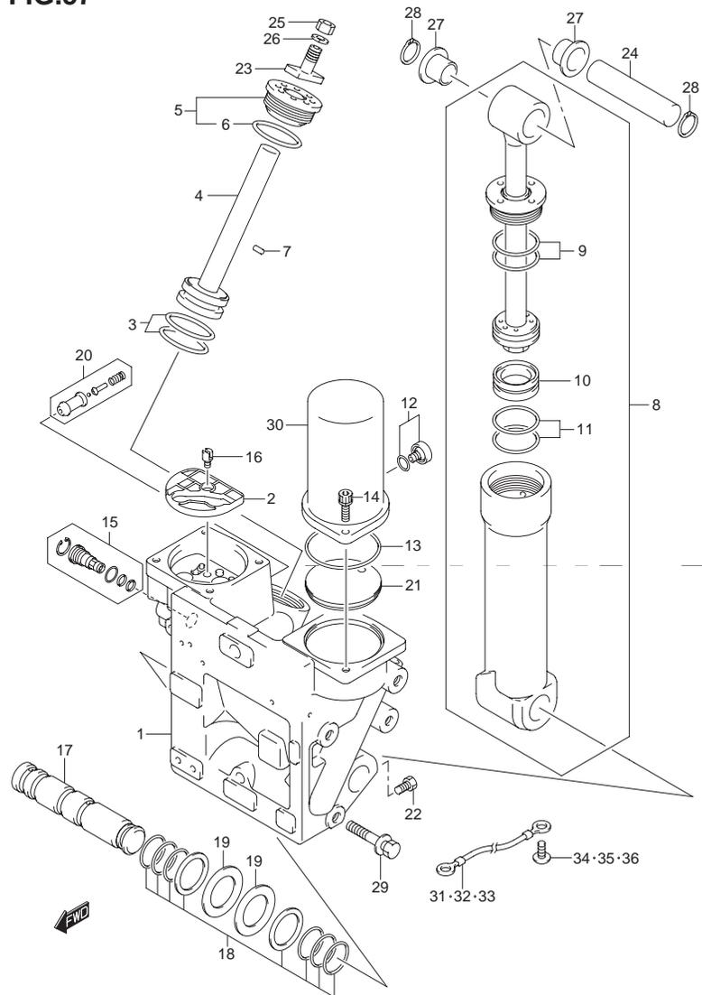
FIG.57 (1-H-7) トリム シリンダ トランサム(X)(DF200T)
