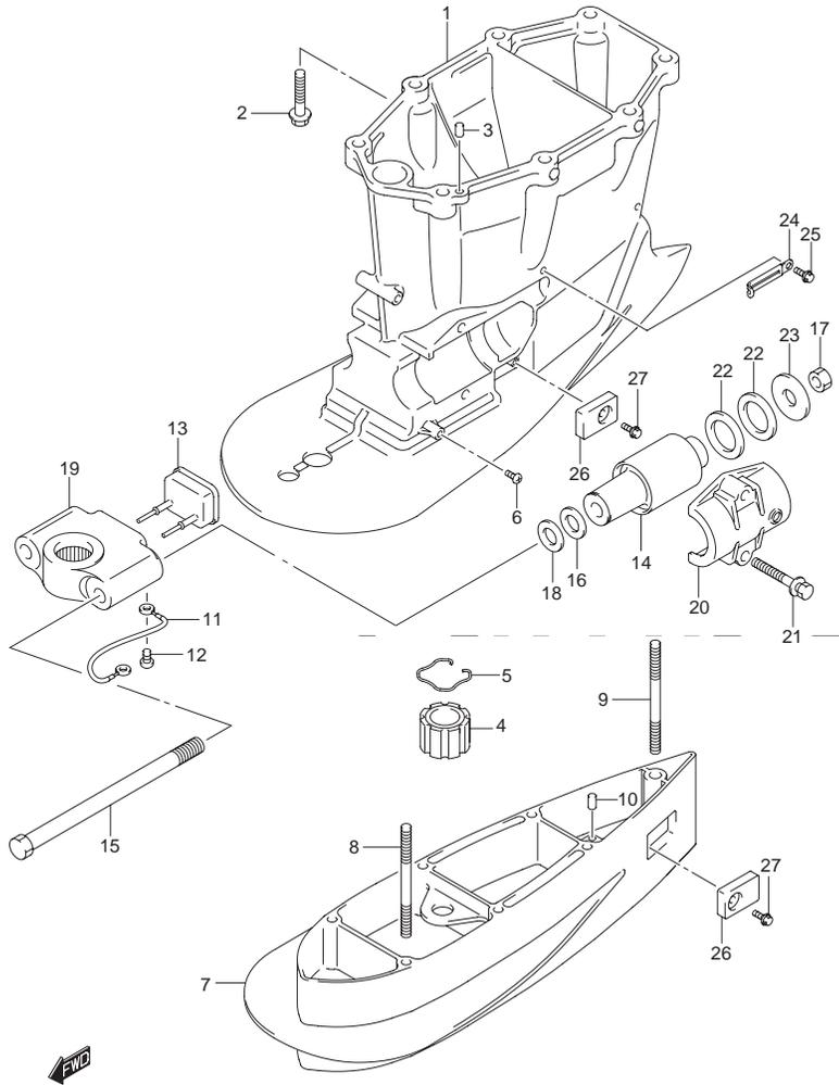
FIG.70 (1-I-12) ドライブシャフトハウジング トランサム(X XX)(DF250T)
