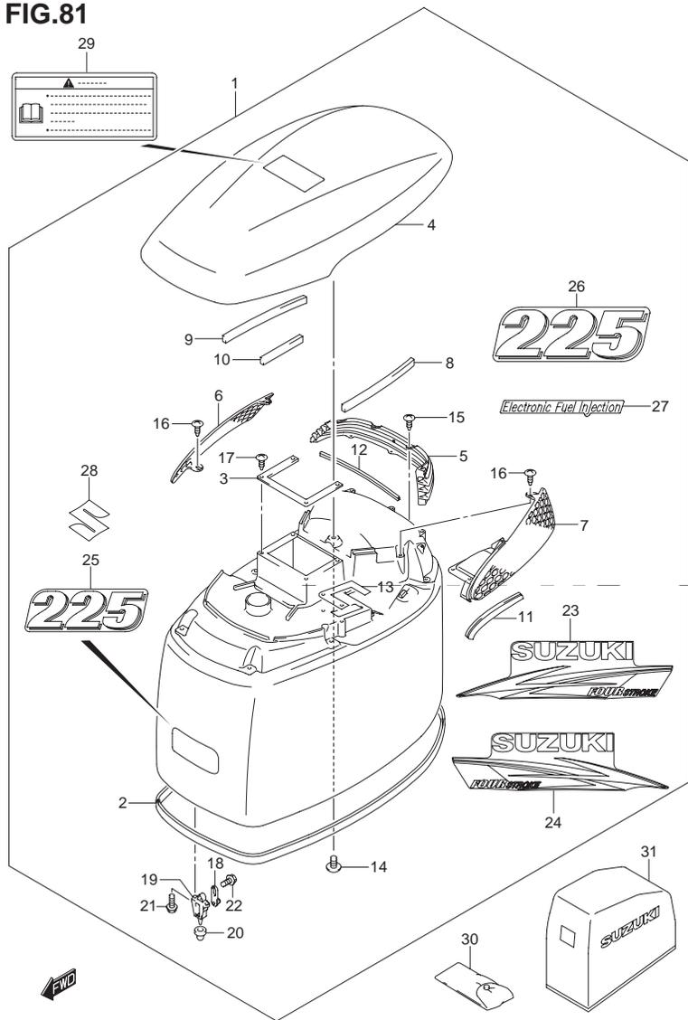
FIG.81 (1-K-9) エンジン カバー( FOR 0EP )( DF225T )
