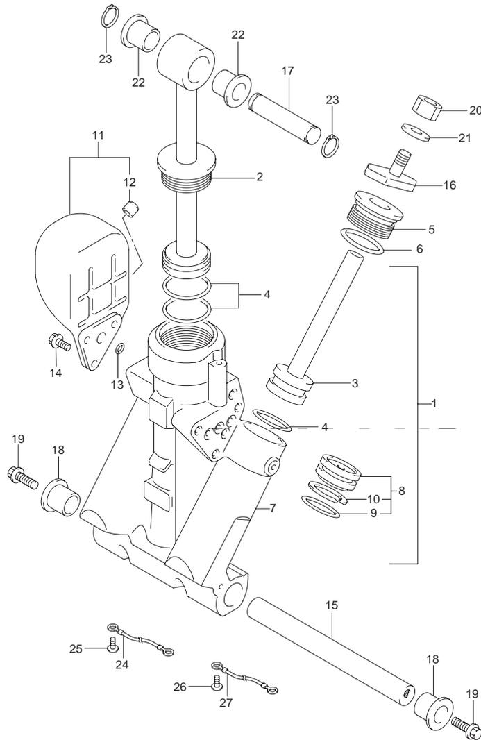
FIG.60 (1-H-12) トリム シリンダ トランサム(L)(DF200T)
