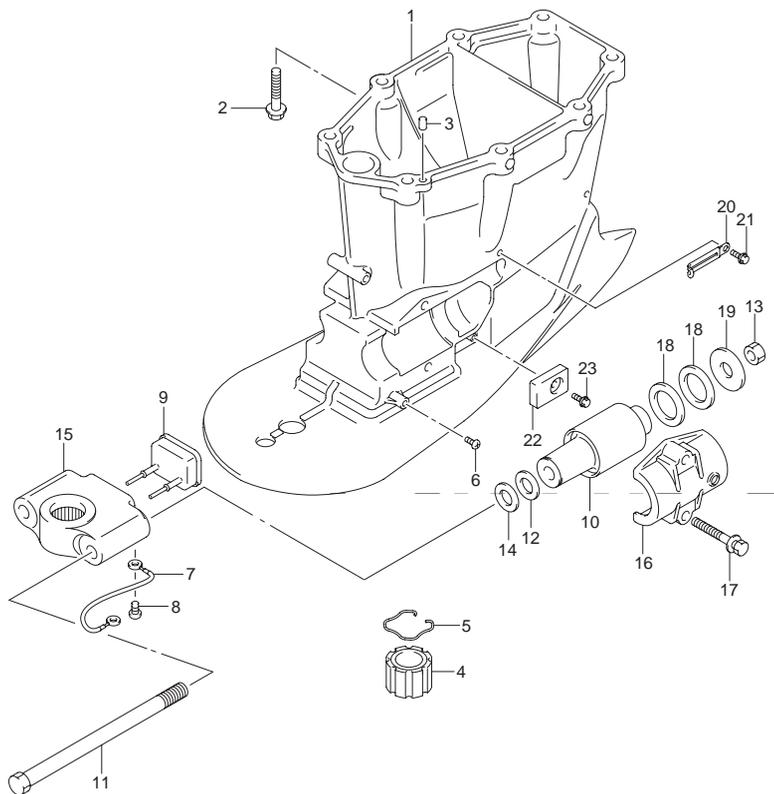
FIG.69 (1-I-11) ドライブシャフトハウジング トランサム(X)(DF225T)
