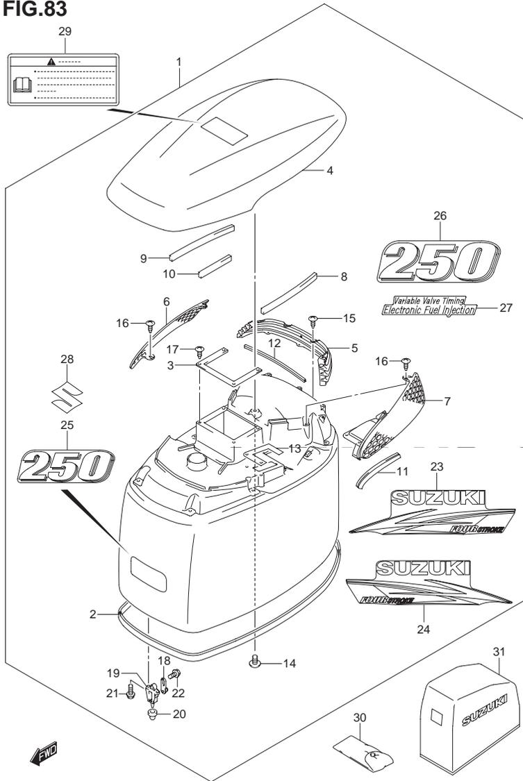
FIG.83 (1-K-14) エンジン カバー (FOR 0EP) (DF250T)
