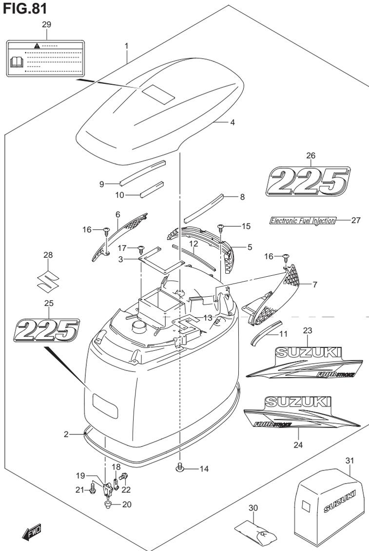
FIG.81 (1-K-10) エンジン カバー (FOR 0EP) (DF225T)
