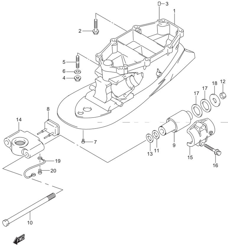
FIG.71 (1-I-14) ドライブシャフトハウジングトランサム(L)(DF200T)
