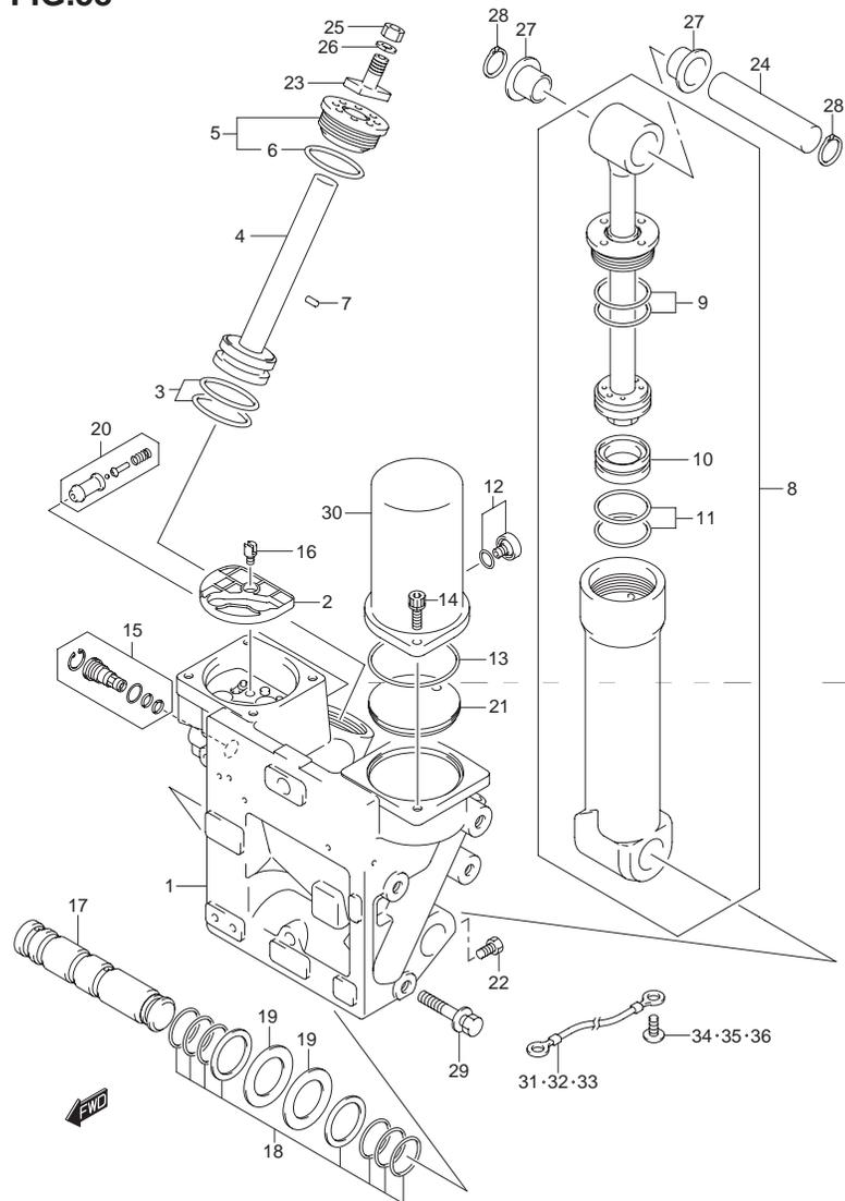
FIG.58 (1-H-8) トリム シリンダ トランサム(X)(DF225T)
