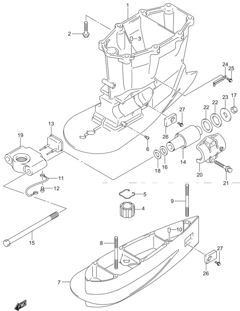
FIG.70 (1-I-13) ドライブシャフトハウジング トランサム(X XX)(DF250T)
