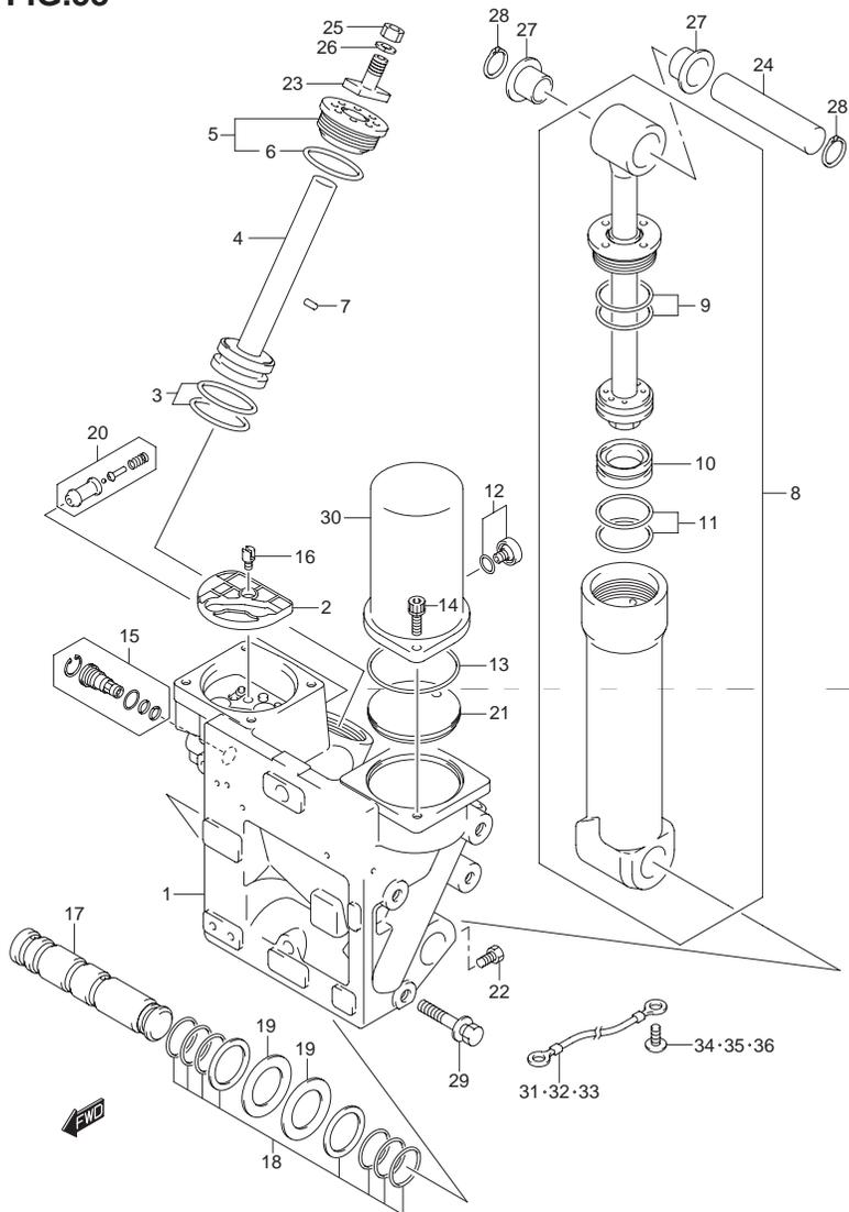
FIG.58 (1-H-9) トリム シリンダ トランサム(X)(DF225T)
