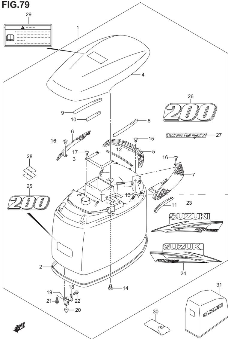
FIG.79 (1-K-5) エンジン カバー( FOR 0EP )( DF200T )
