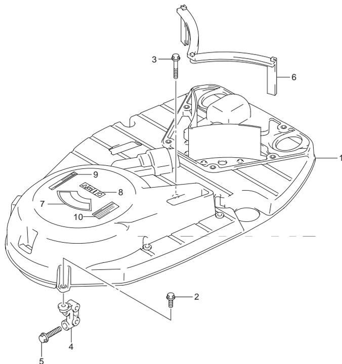
FIG.5 (1-B-9) リングギヤカバー
