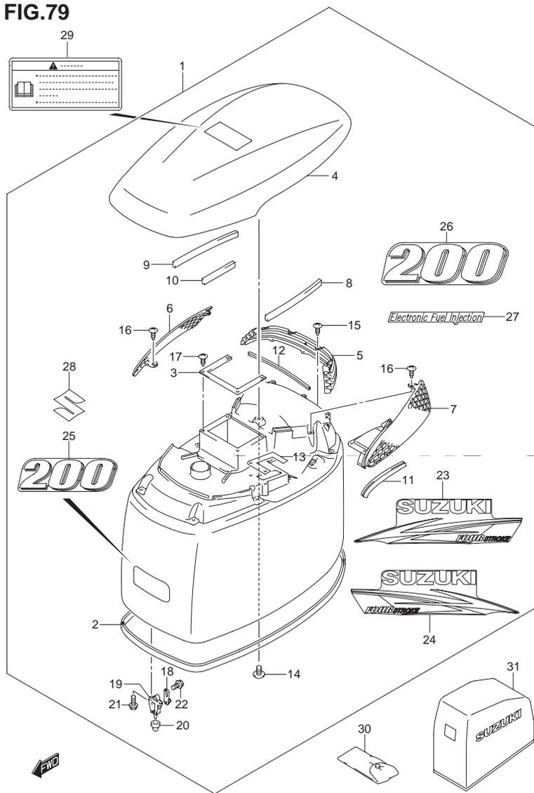
FIG.79 (1-K-6) エンジン カバー(FOR 0EP)(DF200T)
