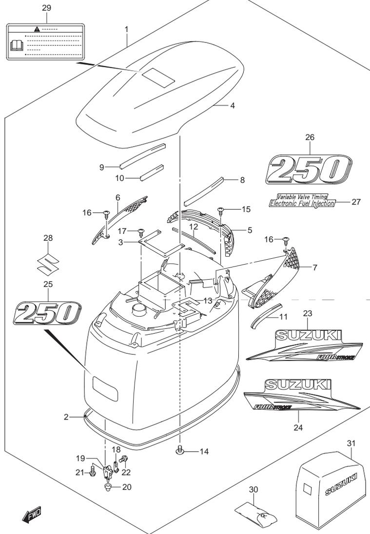
FIG.83 (1-K-13) エンジン カバー( FOR 0EP )( DF250T )
