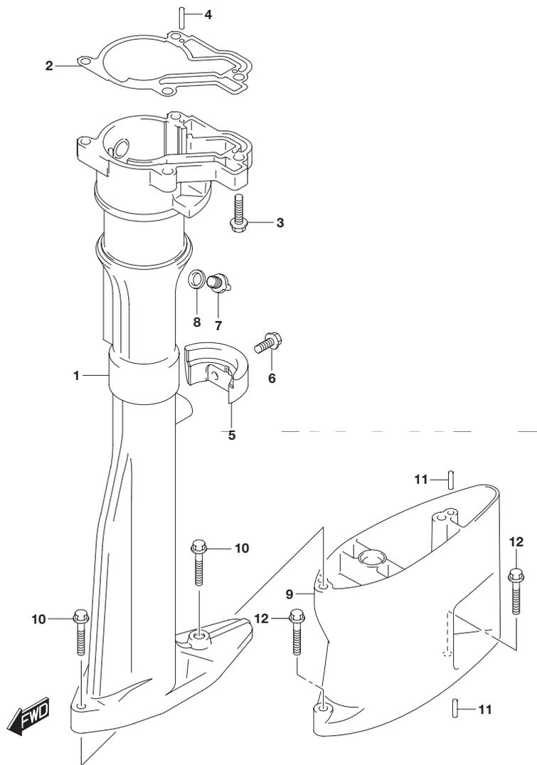
**FIG.405B (1-C-6) ドライブシャフトハウジングトランサム(L)**
