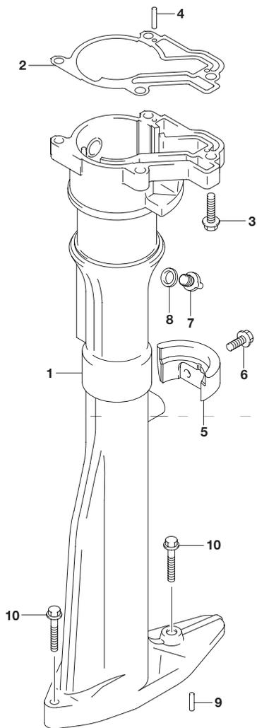
**FIG.405A (1-C-5) ドライブシャフトハウジングトランサム(S)**
