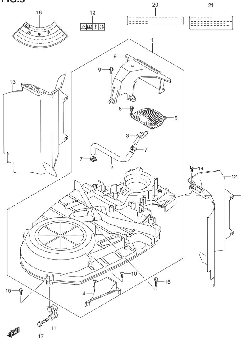
FIG.3 (1-B-6) リングギヤカバー
