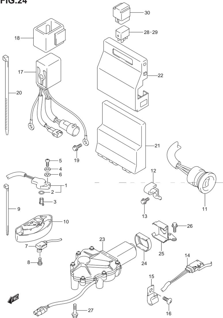
FIG.24 (1-D-9) PTT スイッチ / エンジン コントロール ユニット
