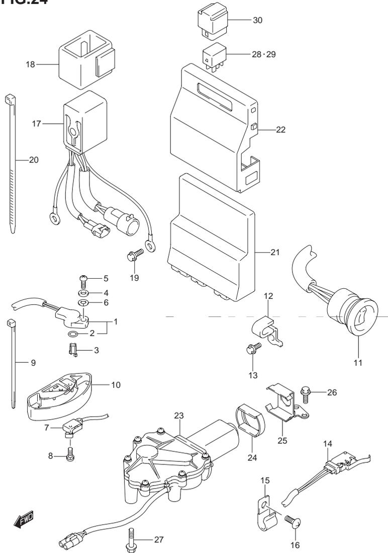
FIG.24 (1-D-8) PTT スイッチ / エンジン コントロール ユニット
