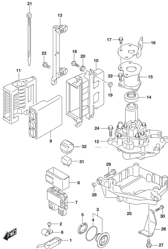
**FIG.326B (1-E-4) PTT スイッチ/エンジン コントロール ユニット (DF325A)**
