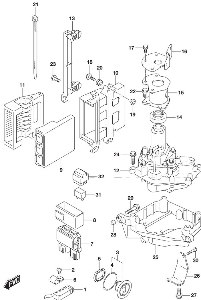
**FIG.326A (1-D-15) PTT スイッチ/エンジン コントロール ユニット (DF350A)**
