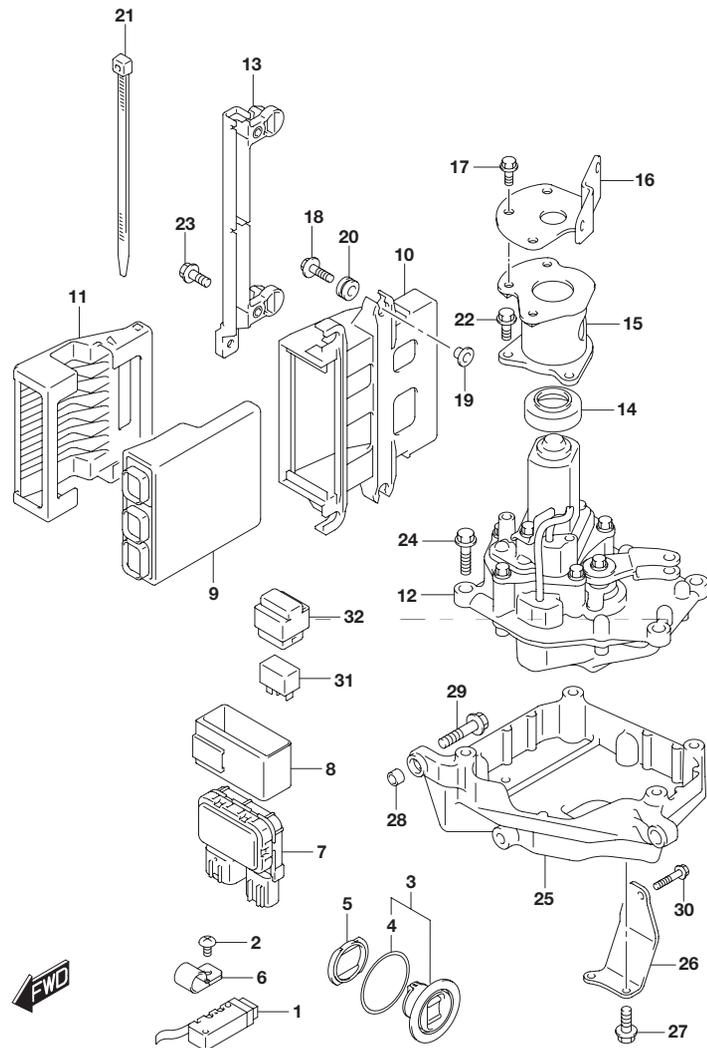
FIG.326B (1-E-3) PTT スイッチ/エンジン コントロール ユニット (DF325A)
