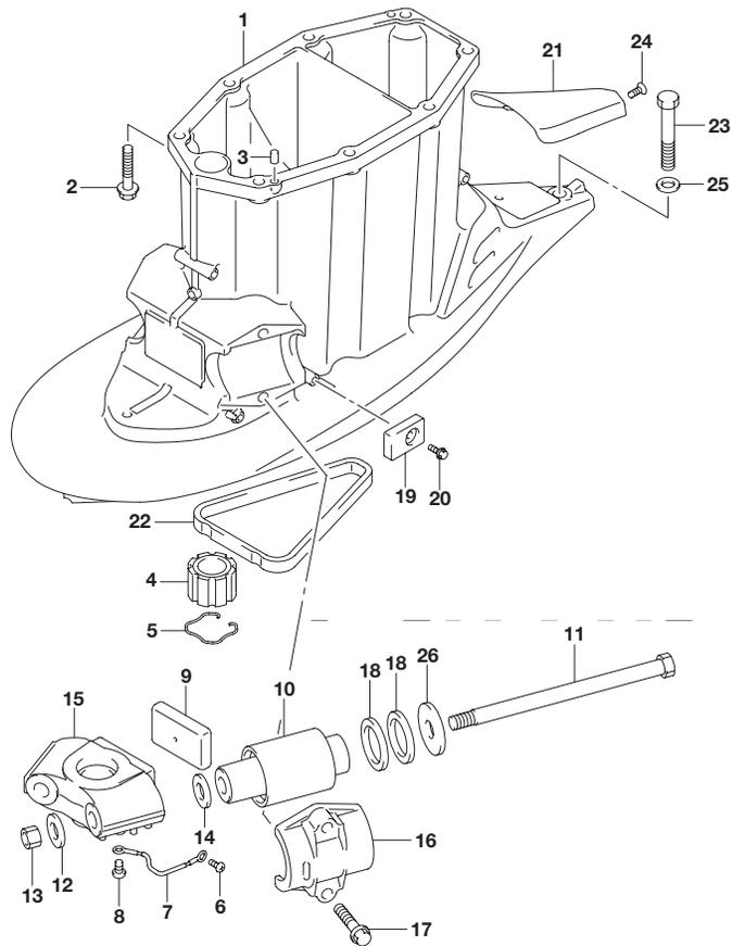
**FIG.405A (1-F-2) ドライブ シャフト ハウジング (X)**
