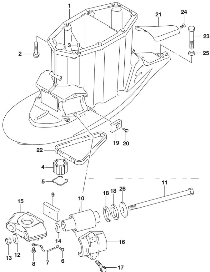
FIG.405A (1-E-15) ドライブ シャフト ハウジング (X)
