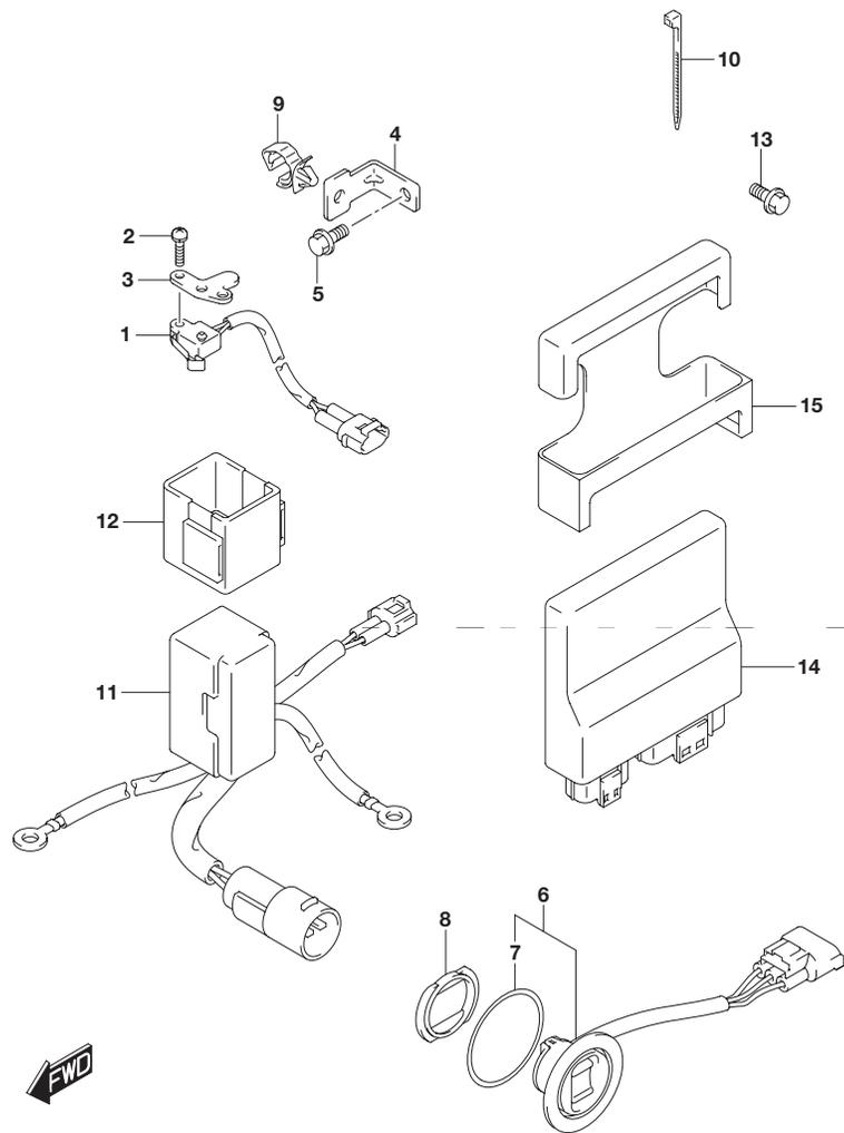
**FIG.326D (1-G-4) PTT スイッチ/エンジン コントロール ユニット(DF90A)**
