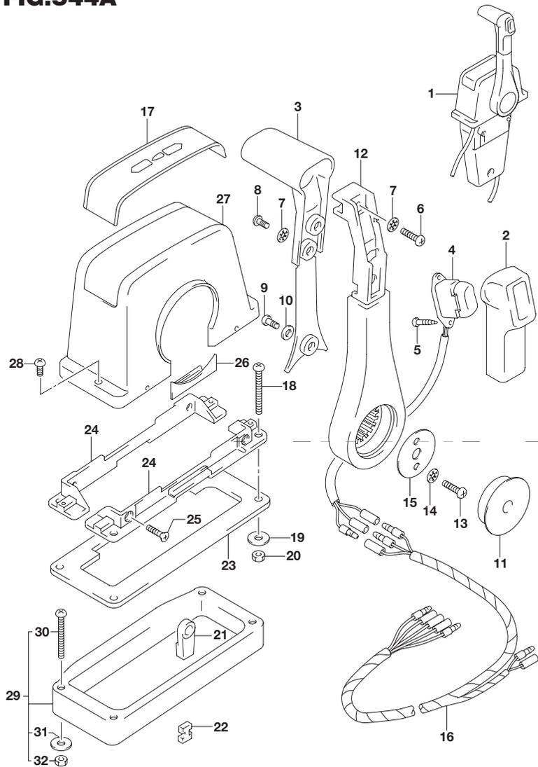
**FIG.544A (2-D-8) オプション:リモートコントロール アッシー シングル(1)(DF70A)**
