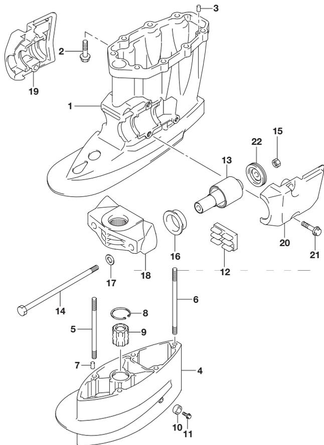
**FIG.405C (1-I-5) ドライブシャフトハウジング(DF80A)**
