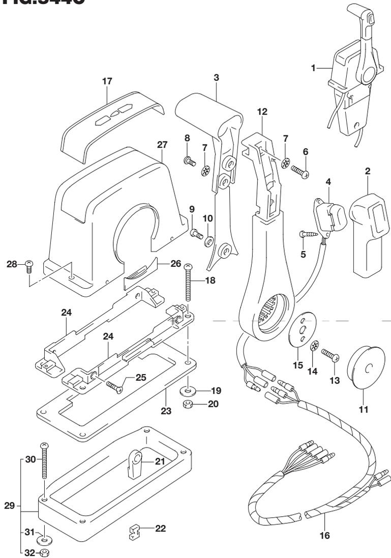
FIG.544C (2-D-11) オプション:リモートコントロール アッシングクル(1)(DF90A)
