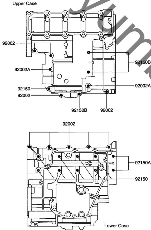
FIG.14 (C-8) クランクケースボルトパターン
