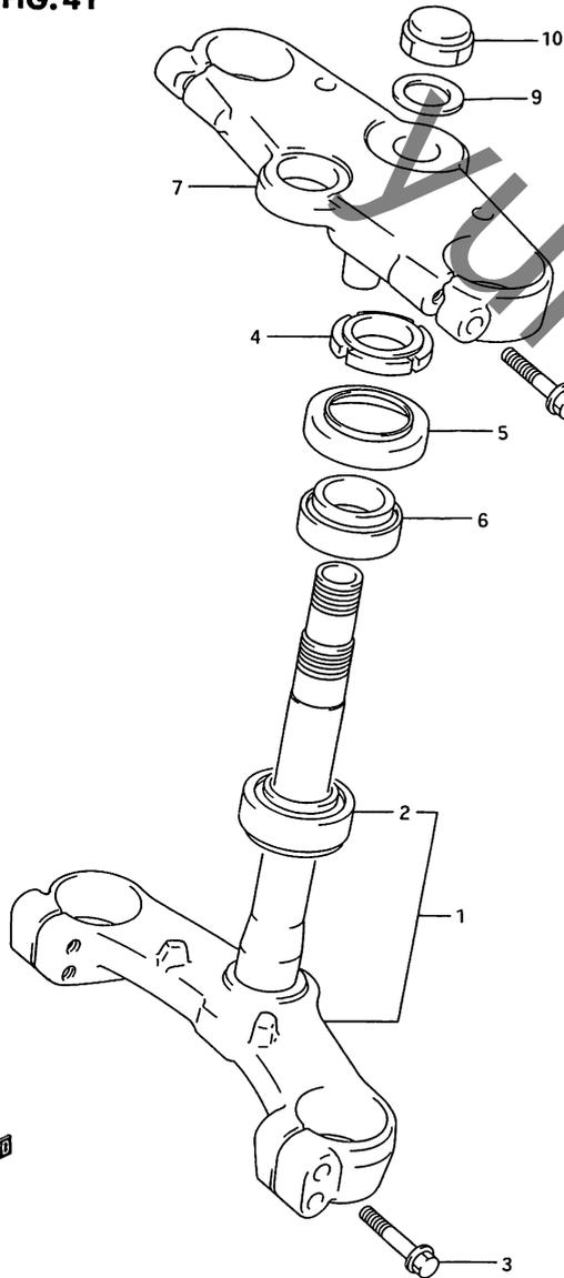
FIG. 41 (F-13) ステアリング ステム
