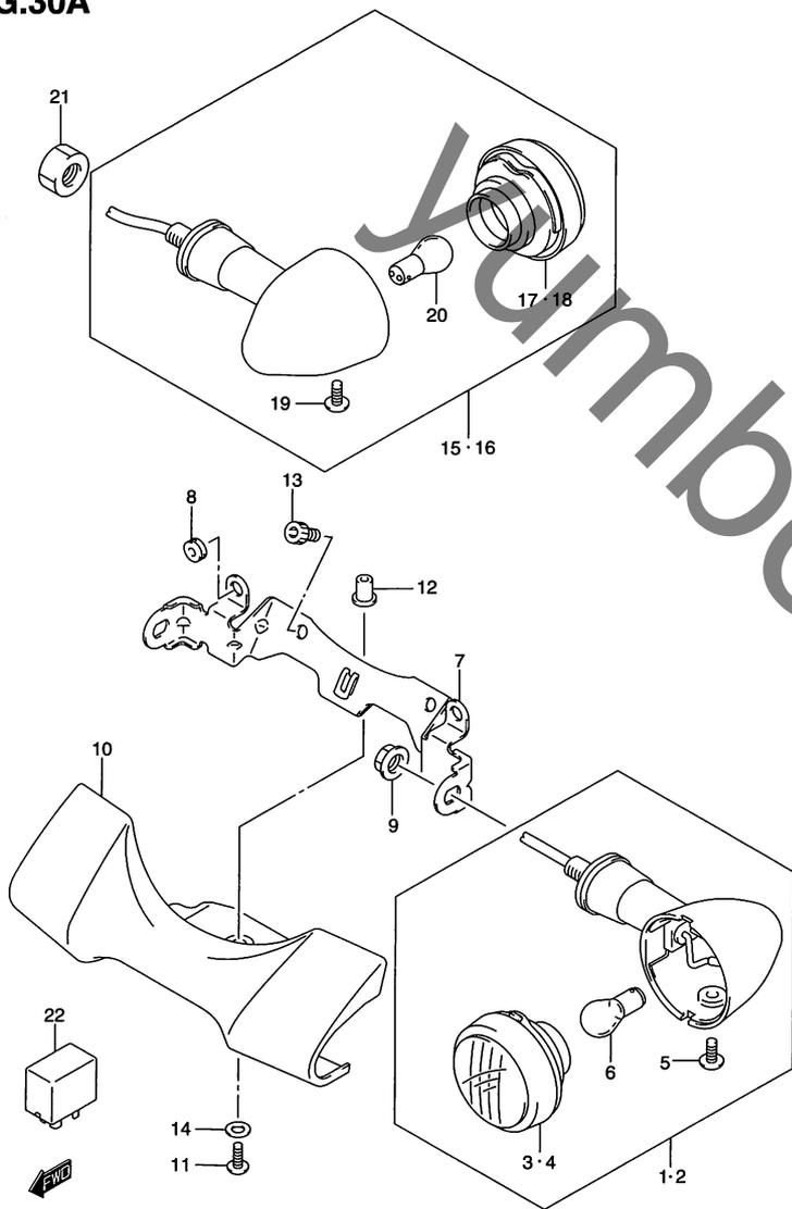
FIG.30A (F-13) ターンシグナル フロント アンド リヤ ランプ (TYPE K4/K5)
