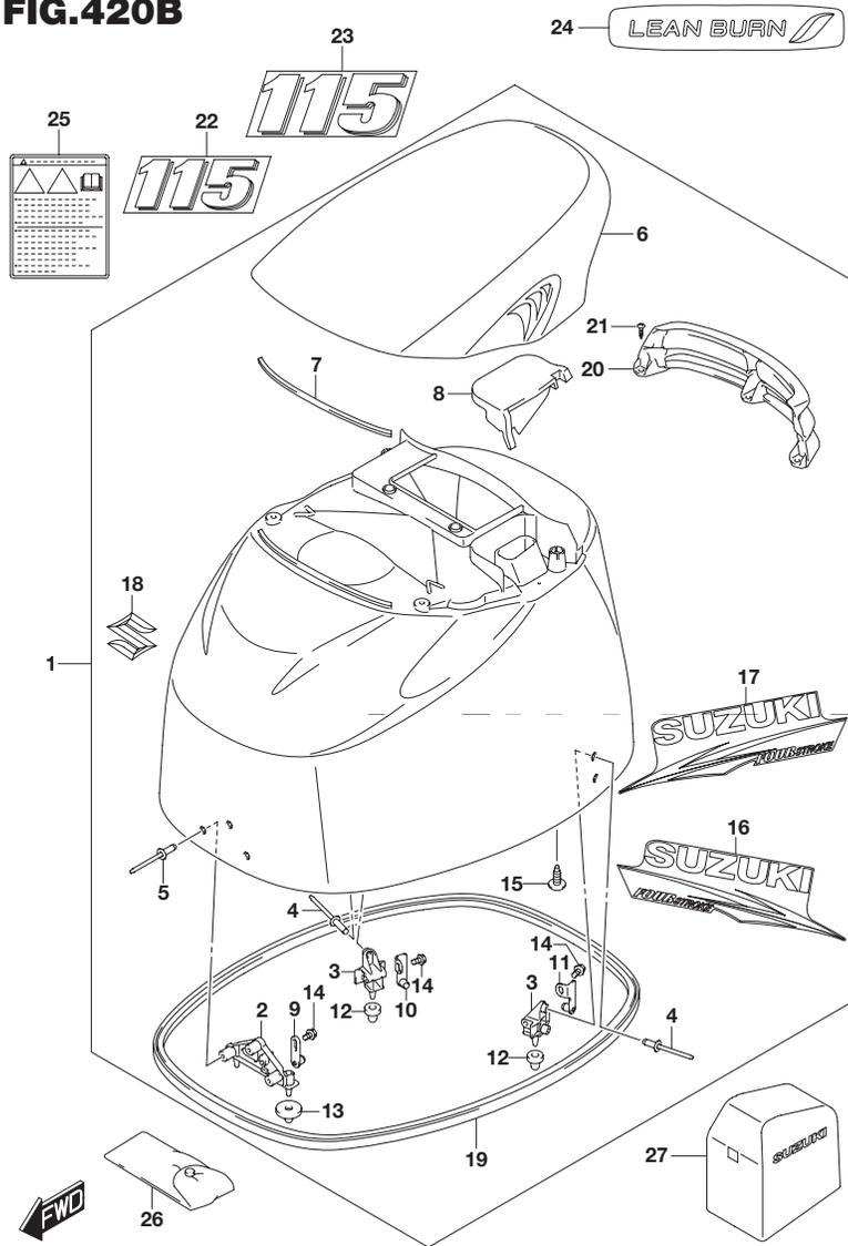
FIG.420B (1-H-12) エンジン カバー(FOR 0EP ,Y5S )(DF115AT)
