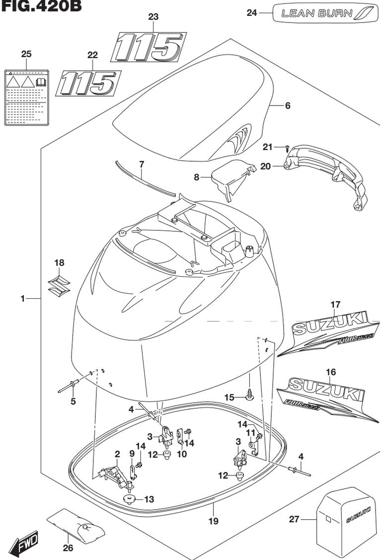
**FIG.420B (1-H-13) エンジン カバー (FOR 0EP ,Y5S )(DF115AT)**
