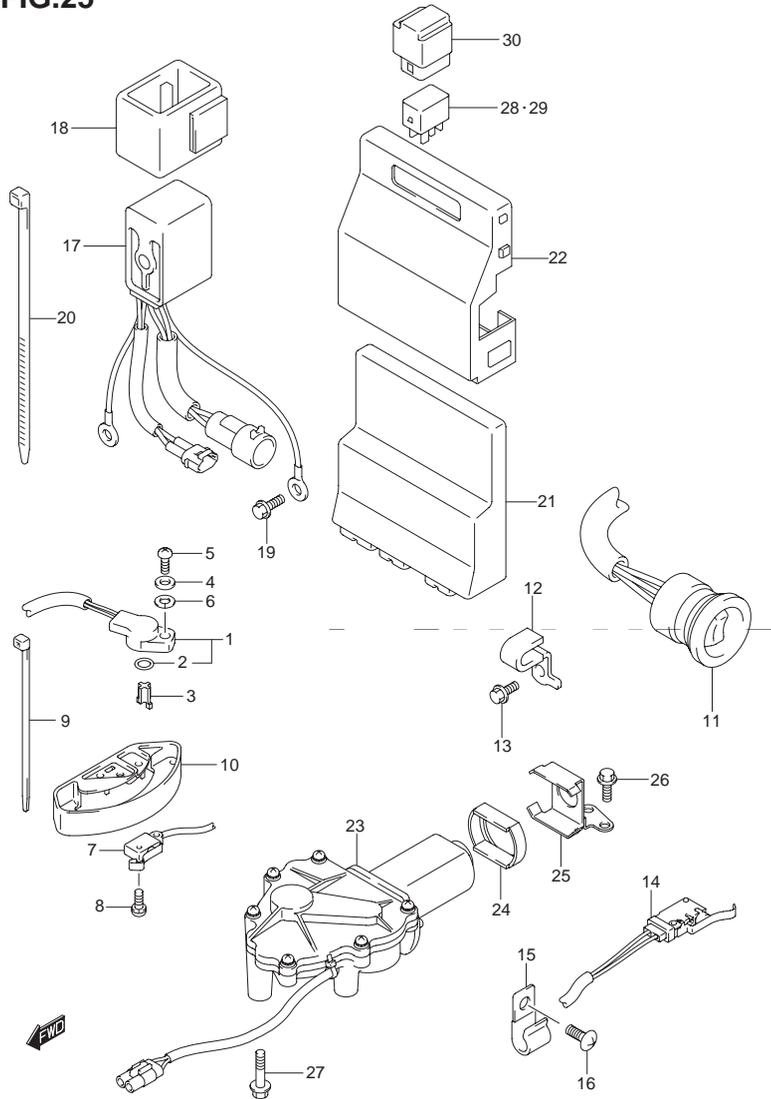
FIG.25 (1-E-2) PTT スイッチ / エンジン コントロールユニット(DF250A)
