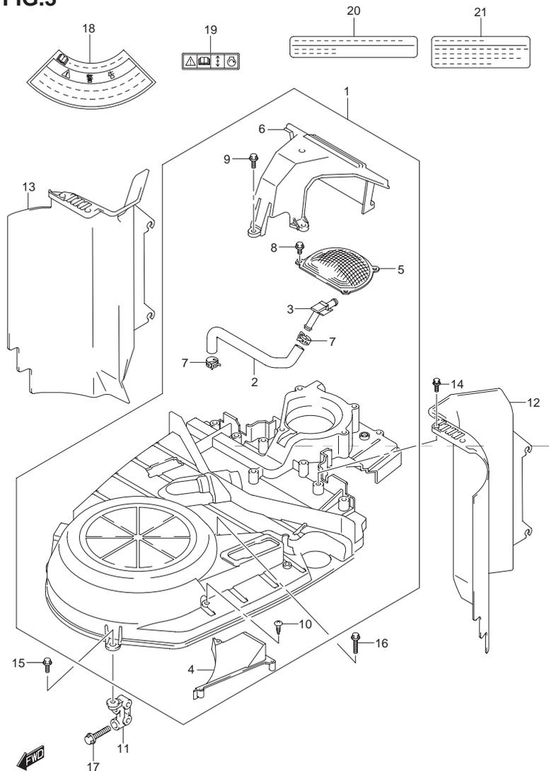
FIG.3 (1-B-6) リングギヤカバー
