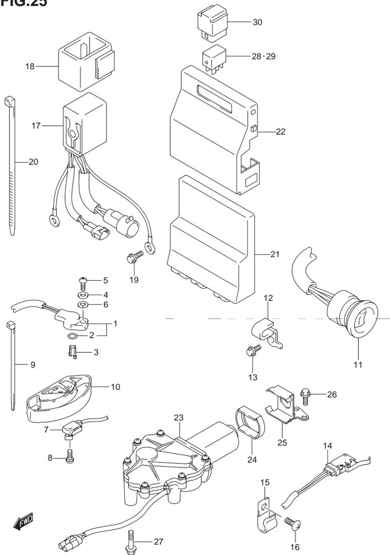
FIG.25 (1-E-3) PTT スイッチ / エンジン コントロールユニット(DF250A)
