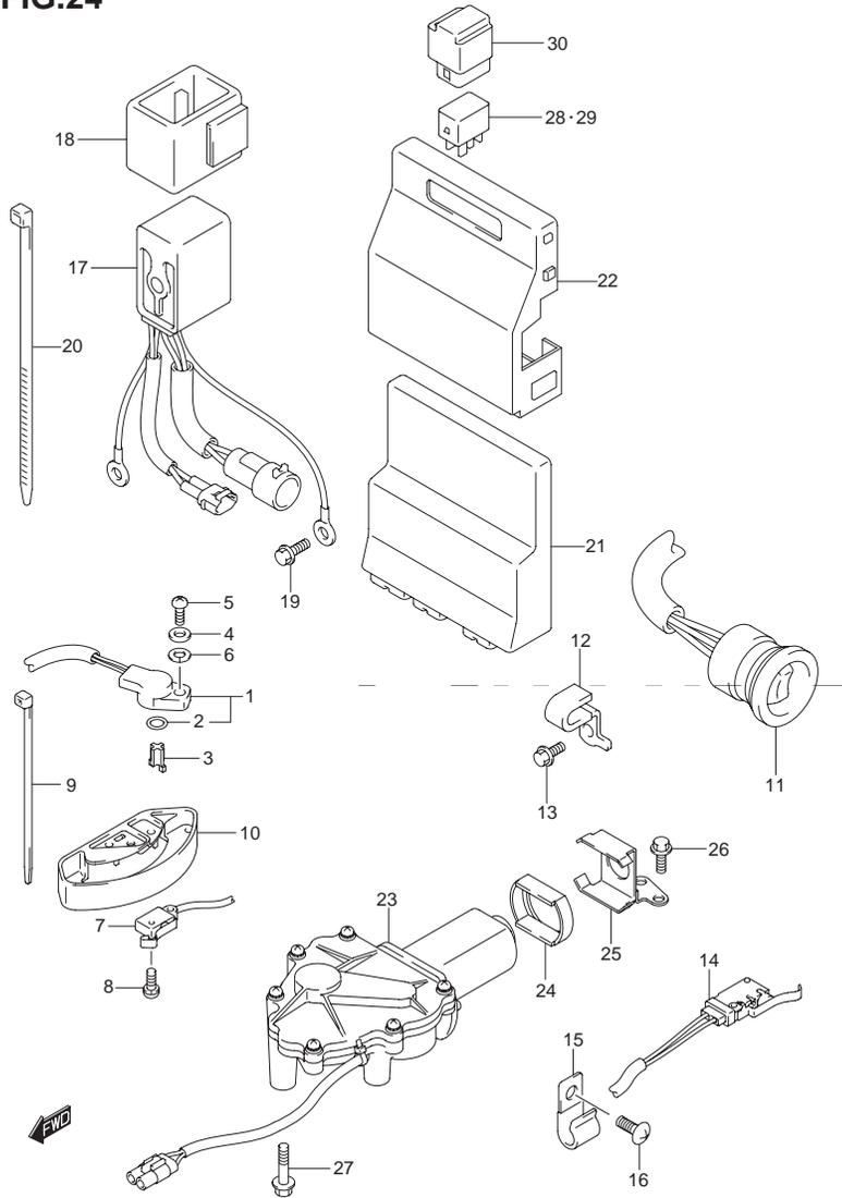
FIG.24 (1-D-15) PTTスイッチ / エンジンコントロールユニット(DF300A)
