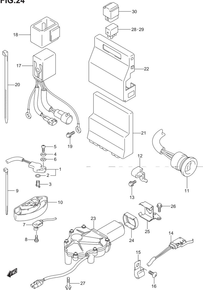
FIG.24 (1-D-14) PTT スイッチ / エンジン コントロール ユニット(DF300A)
