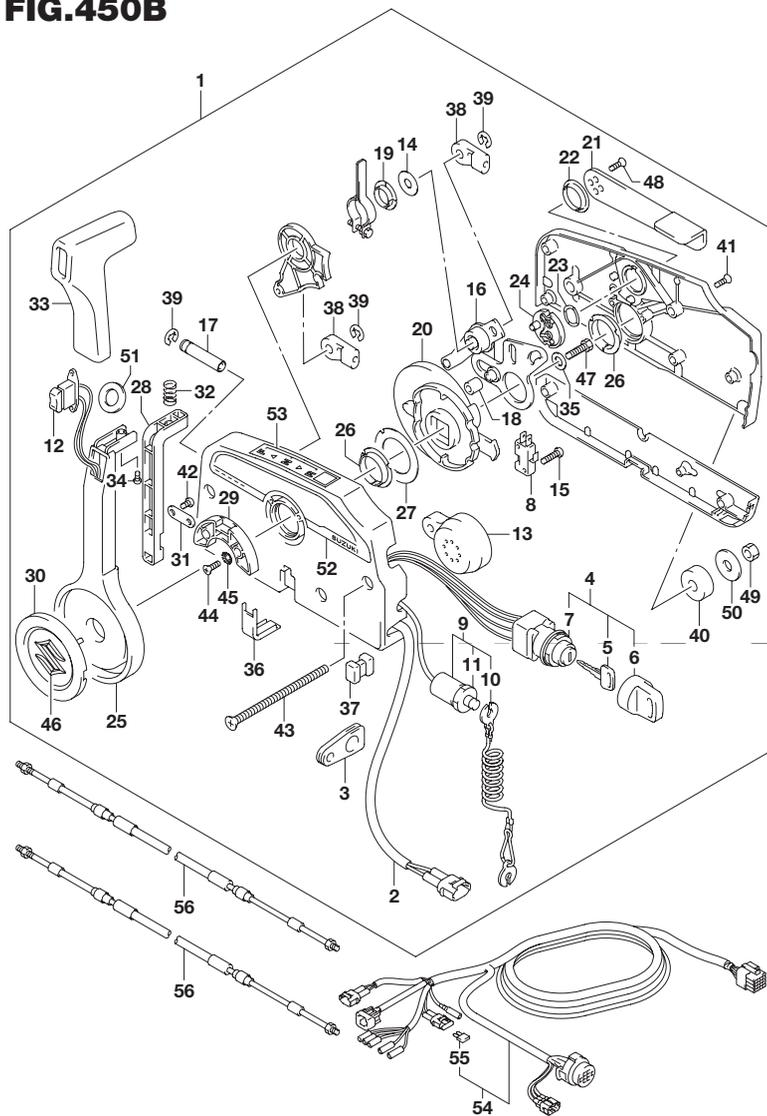
FIG.450B (2-D-13) リモートコントロール(DF30AT)
