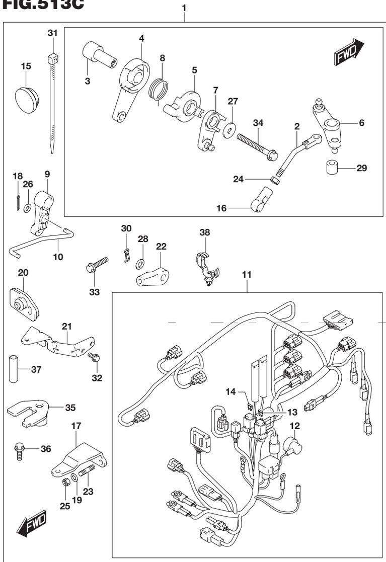
FIG.513C (2-F-11) オプション:リモートコントロールパーツ(DF30A)
