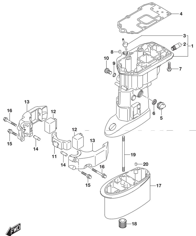
**FIG.405E (1-K-14) ドライブシャフトハウジング(DF30AT)**
