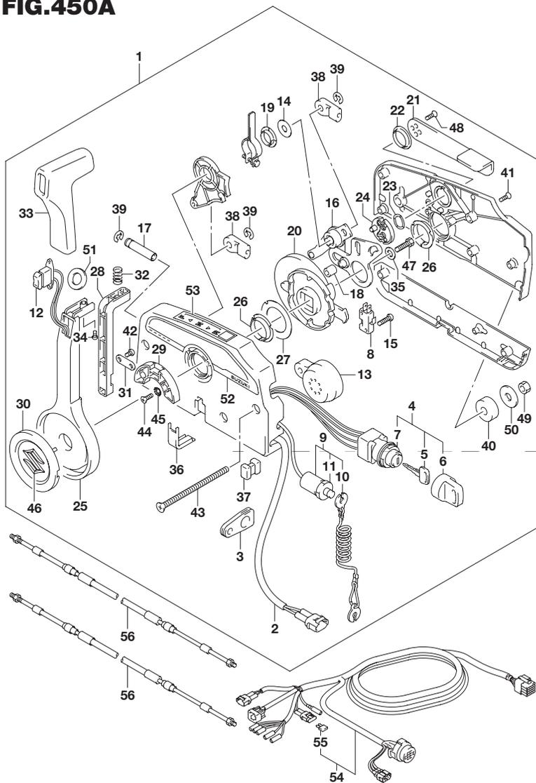
FIG.450A (2-D-9) リモートコントロール(DF25AT)
