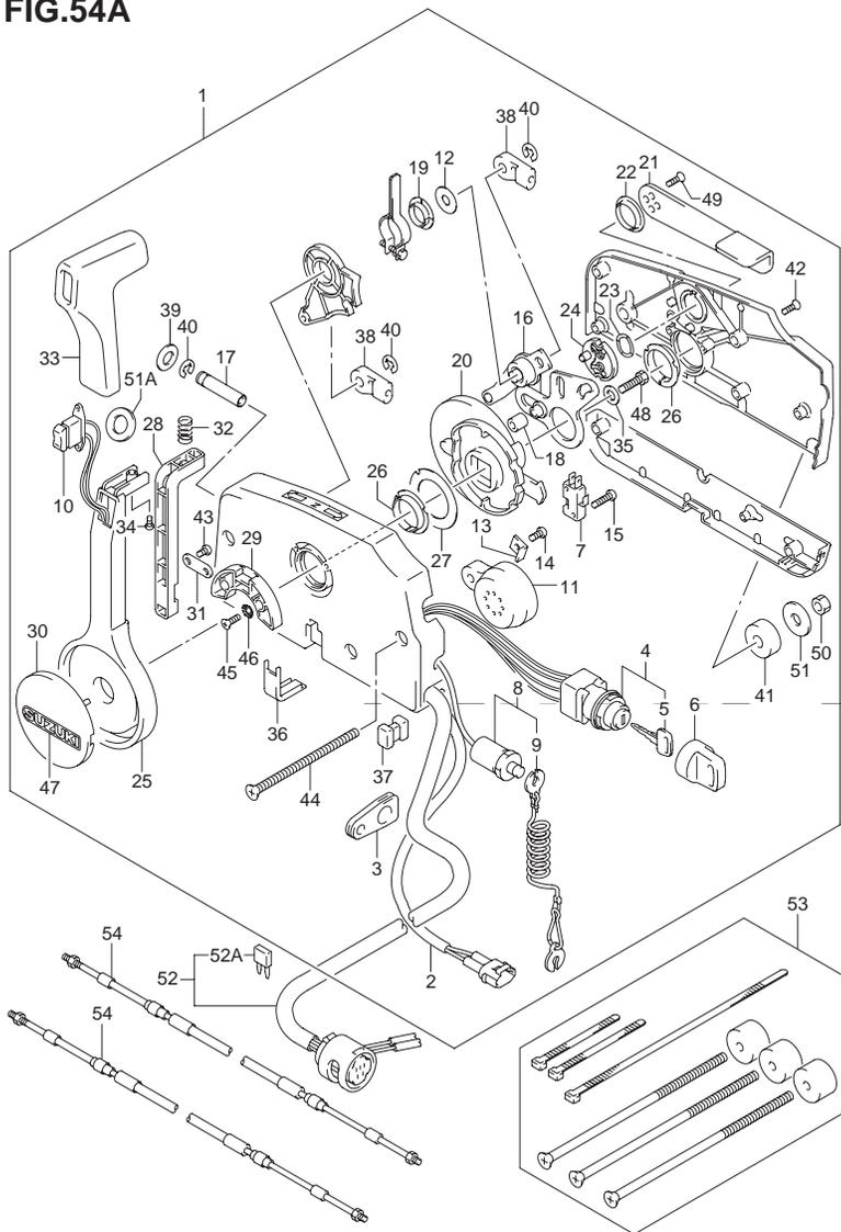
FIG.54A (J-10) リモートコントロール(MODEL:05~09)
