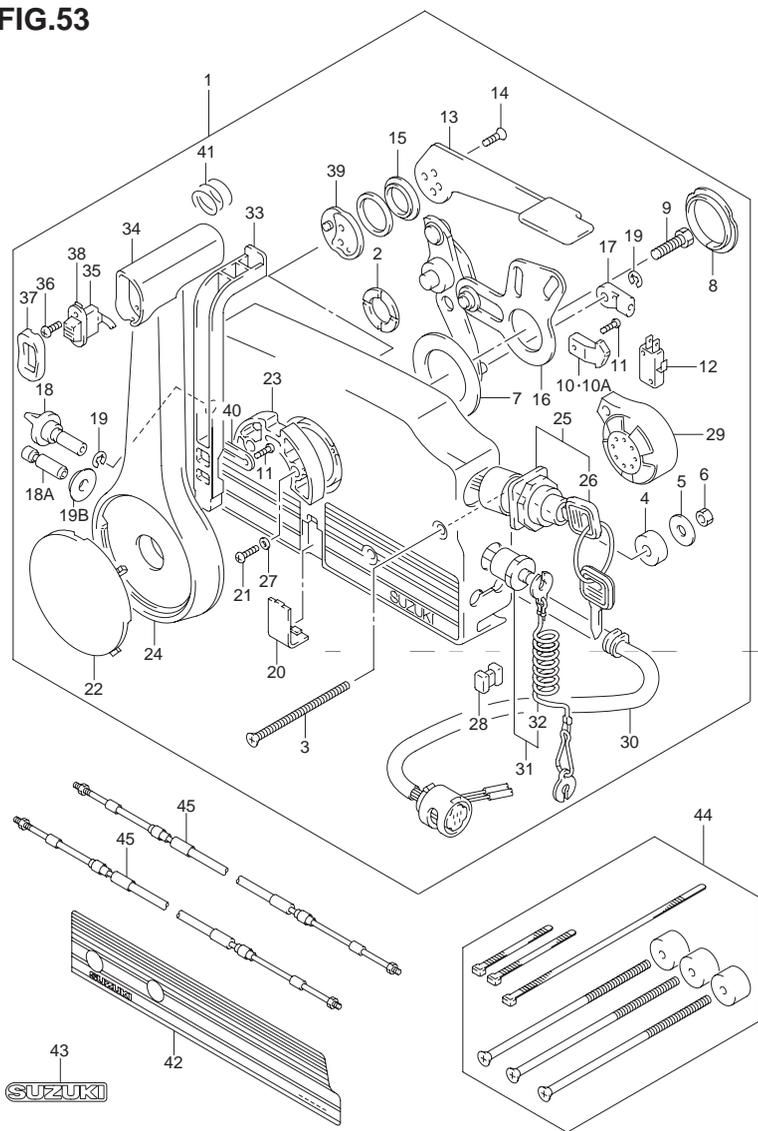
FIG.53 (J-3) リモートコントロール(MODEL:98~03)
