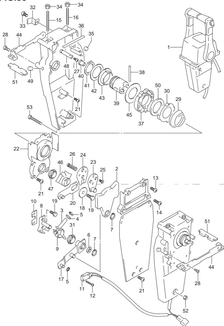
FIG.58 (K-8) リモートコントロール(TWIN 2)
