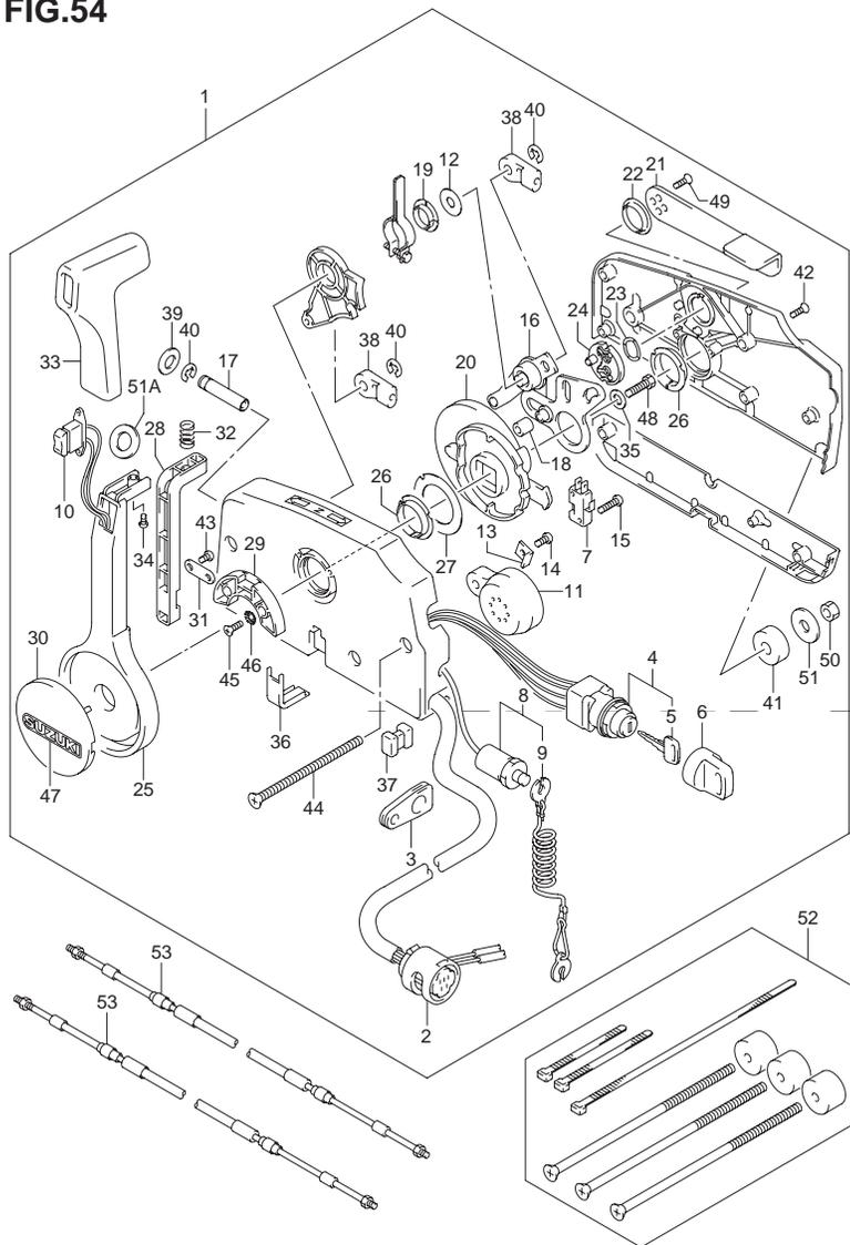
FIG.54 (J-6) リモートコントロール(MODEL:04)
