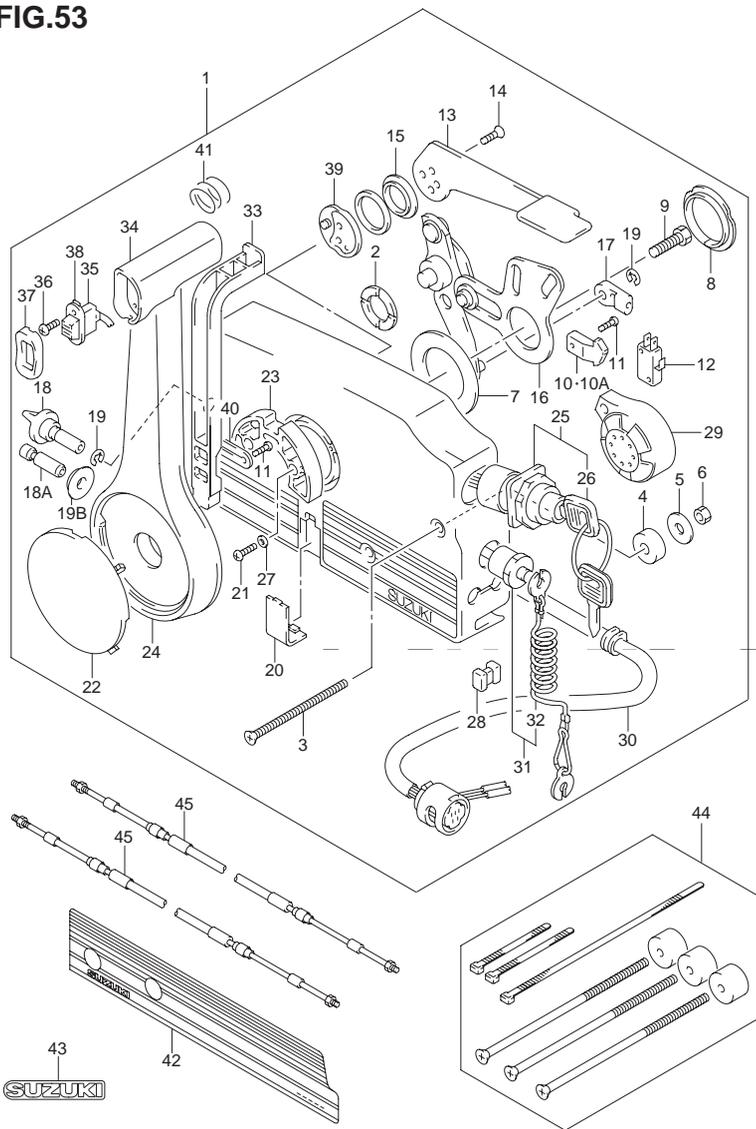
FIG.53 (J-2) リモートコントロール(MODEL:98~03)
