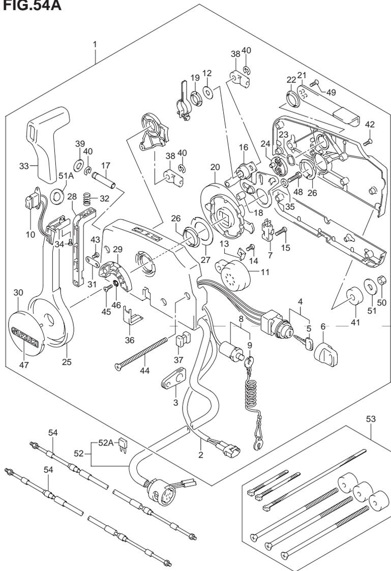
FIG.54A (J-9) リモートコントロール(MODEL:05~09)
