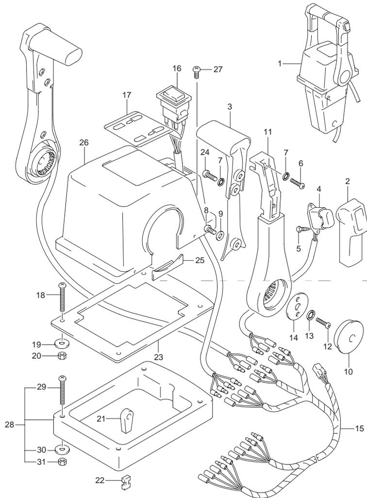
FIG.57 (K-6) リモートコントロール(TWIN 1)
