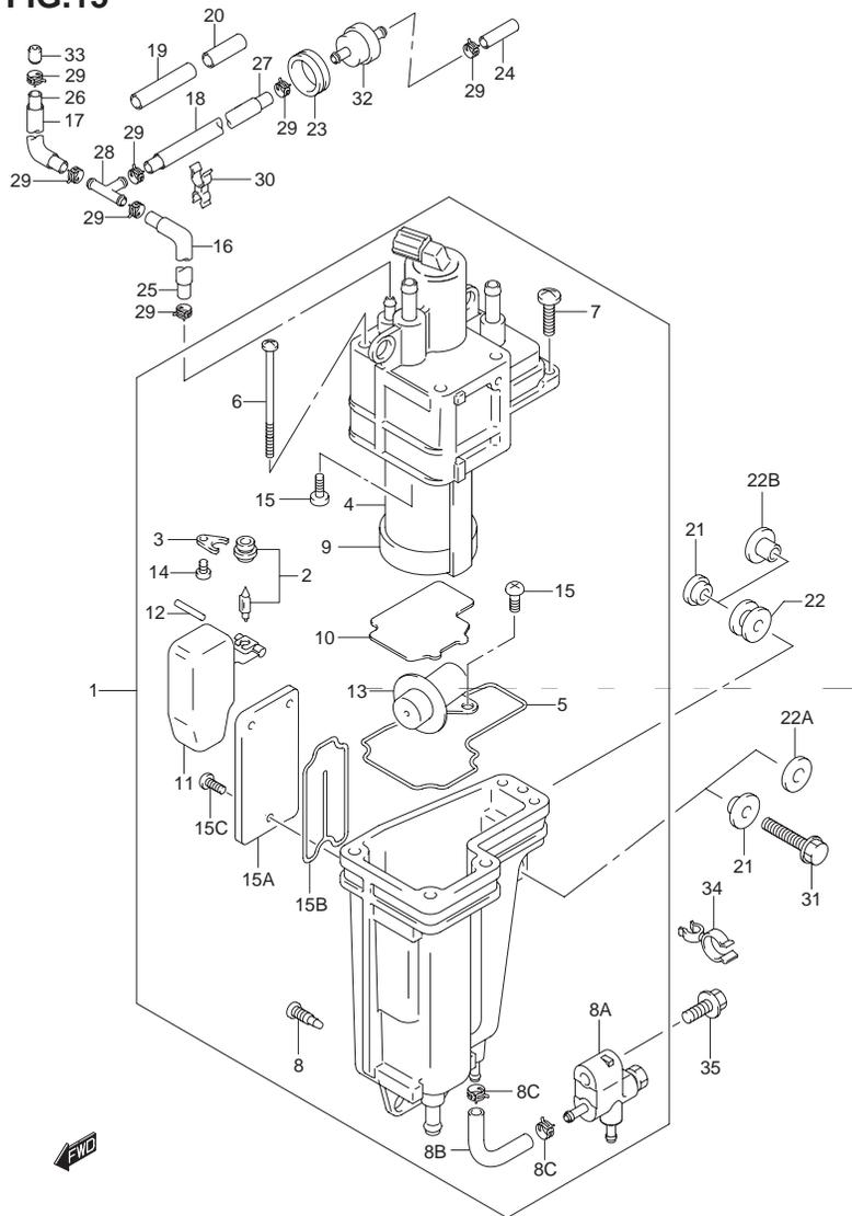
FIG.15 (C-6) フューエルベーパーセパレータ (MODEL:01~09)
