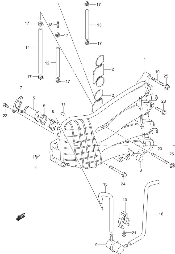
FIG.10 (B-16) インレットマニホールド(DF60 MODEL:02~09/DF70 MODEL:01~08)
