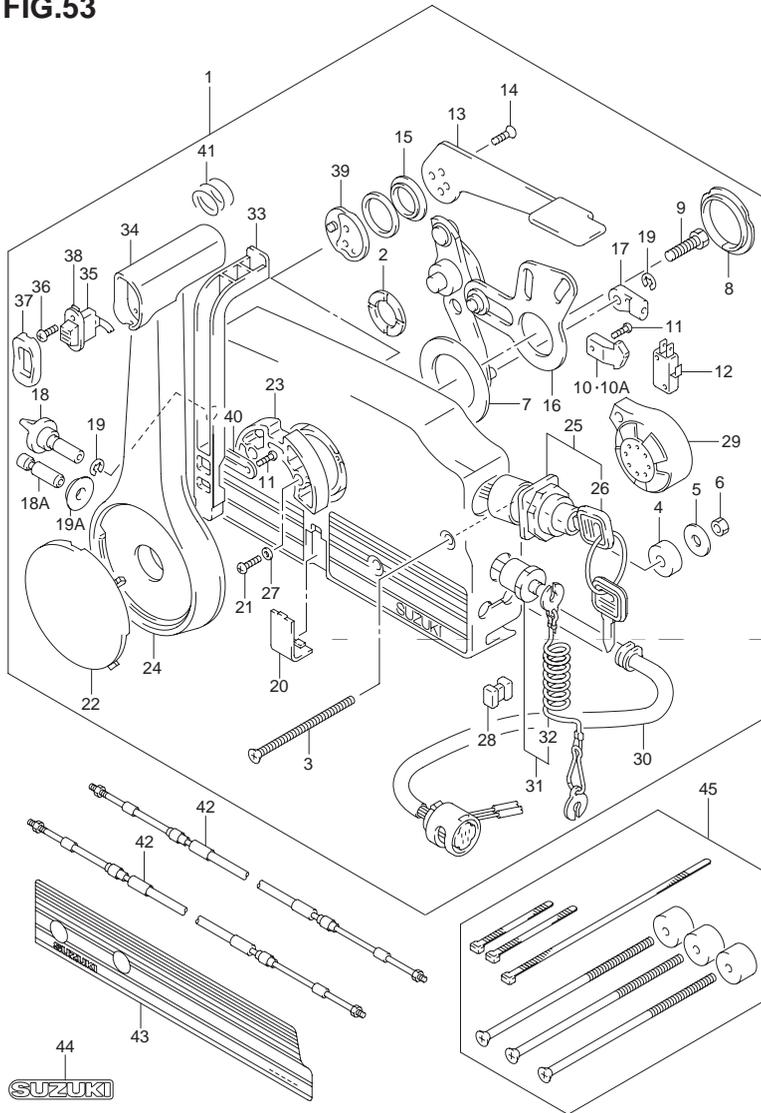
FIG.53 (J-6) リモートコントロールボックス (MODEL:01~03)
