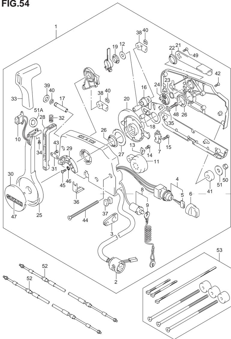
FIG.54 (J-10) リモートコントロールボックス (MODEL:04)
