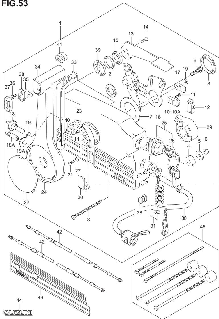
FIG.53 (J-8) リモートコントロールボックス (MODEL:01~03)
