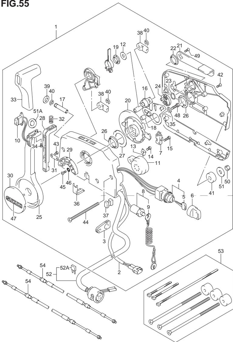
FIG.55 (J-13) リモートコントロール (MODEL:05~)
