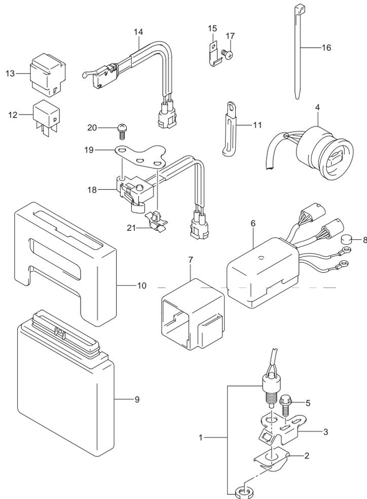
FIG.35 (F-11) エンジンコントロールユニット (MODEL:04~)
