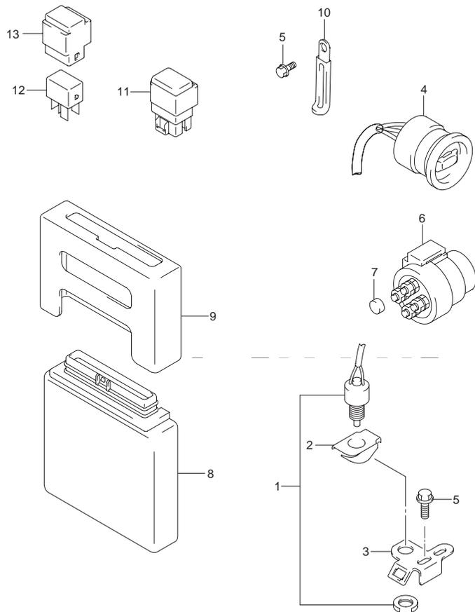
FIG.34 (F-9) エンジンコントロールユニット (MODEL:01~03)
