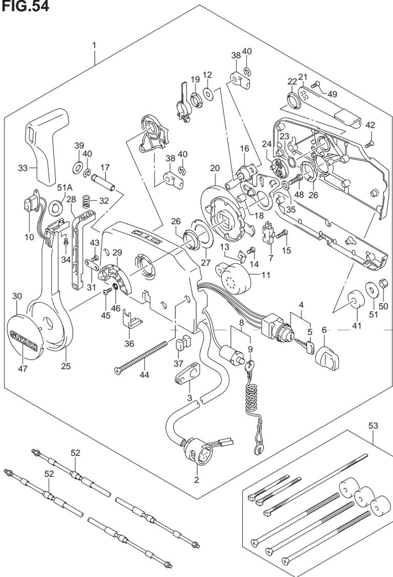
FIG.54 (J-9) リモートコントロールボックス (MODEL:04)
