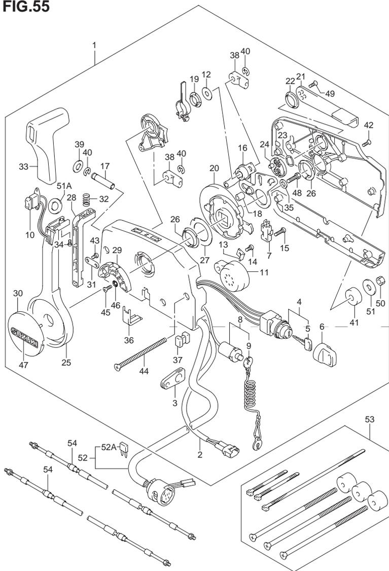
FIG.55 (J-14) リモートコントロール (MODEL:05~)
