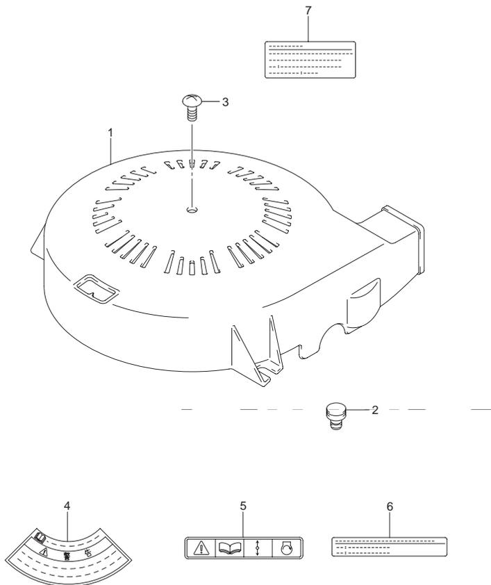
FIG.3 (B-5) リングギヤカバー
