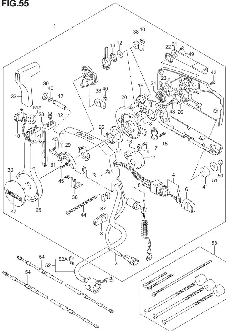
FIG.55 (J-12) リモートコントロール (MODEL:05~)
