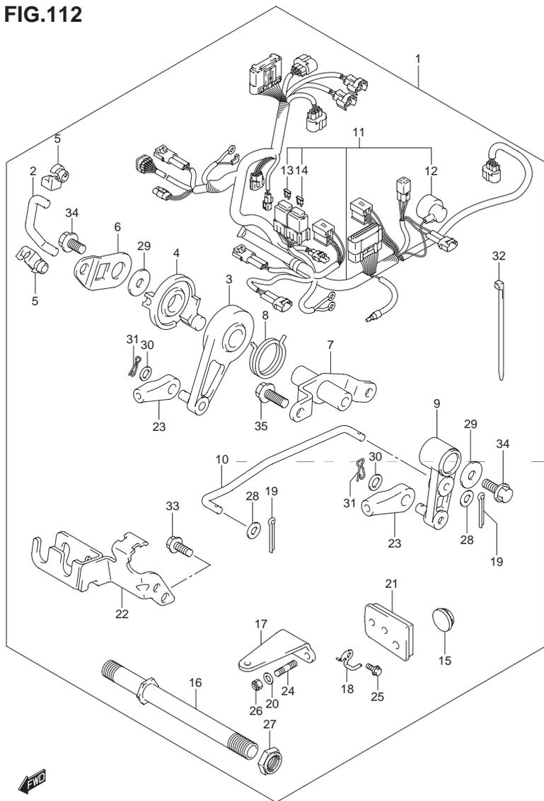
FIG.112 (1-L-11) オプション:リモートコントロールパーツ(DF20A)
