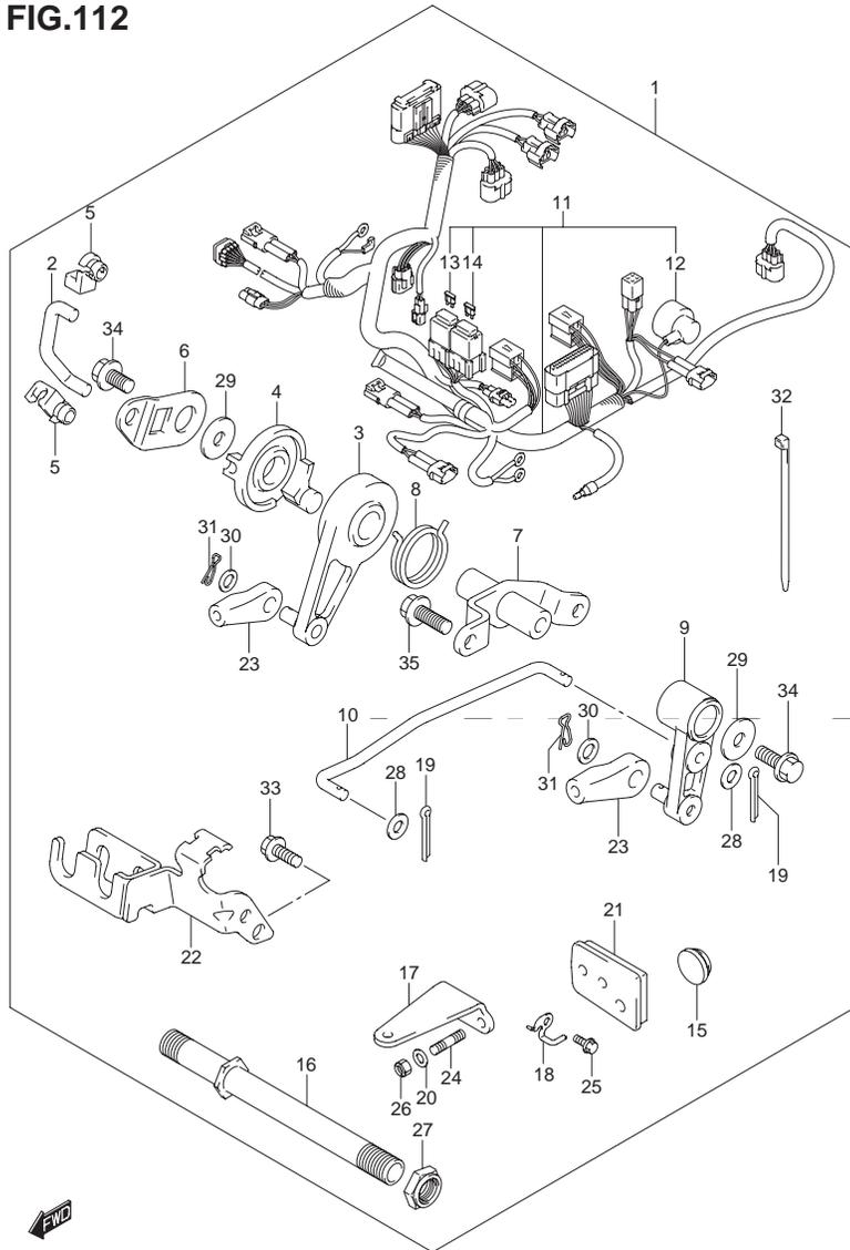
FIG.112 (1-L-10) オプション:リモートコントロールパーツ(DF20A)
